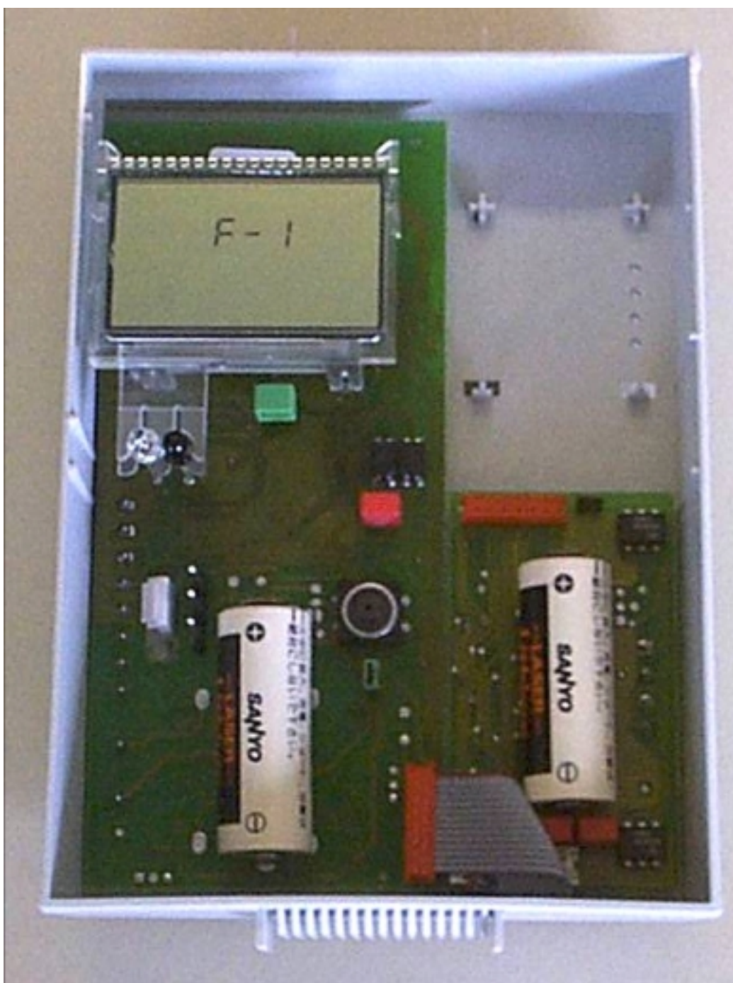
Slika 7: Otvorena računska jedinica (Glavna tiskana pločica za baterijsko napajanje i Relejna tiskana pločica)
