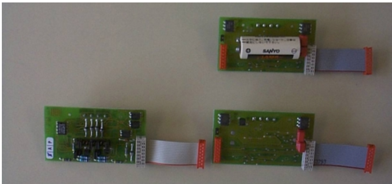
Slika 5: Dodatne tiskane pločice (Digitalno-analoga tiskana pločica i Relejna tiskana pločica za mrežno i baterijsko napajanje)
